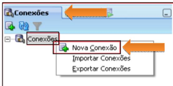
3. Escolha o nome da nova conexão, neste exercício será: BIDW. Coloque **BIDW** em nome do usuário, coloque a senha **oracle11g**, e SID **ORCL**. Clique em testar, se o Status estiver com sucesso, clique em **CONECTAR**.
